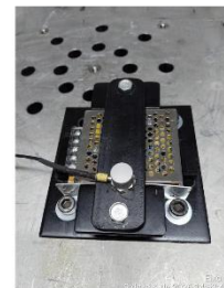
Imagem 12: Conjunto suporte/amostra instalado
