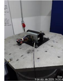
Imagem 30: Conjunto suporte/amostra instalado
