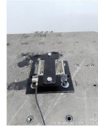
Imagem 11: Conjunto suporte/amostra instalado
