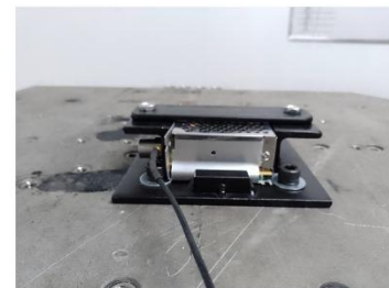
Imagem 10: Conjunto suporte/amostra instalado
